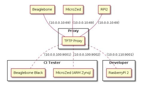
Fig. 14.1: RTEMS TFTP Proxy Test Lab
