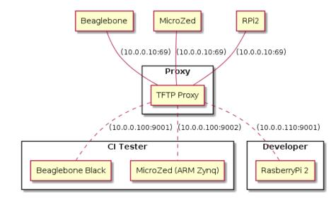
Fig. 14.1: RTEMS TFTP Proxy Test Lab
